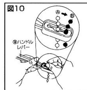
10. 弁の鎖をハンドルレバーの大きい穴へ差し込み、鎖の状態を図11のように調節し、Aの位置からBの位置へ押しながら差し込んでください。
