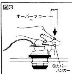
3. オーバーフロー管のカバーハンガーへ弁の穴をあわせ図3のように強く差し込んでください。
