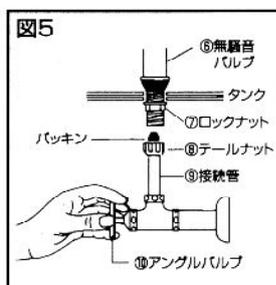
5. アングルバルブとバルブを連結する前にアングルバルブを開けて水を通し、異物を完全に除去してから接続管(フレキシブルホース)を取り付けてください。
