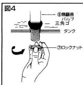
4. バルブを設置完成図と同じ方向になるように注意し、タンクの中から差し込んでから下からロックナットを矢印方向へ取り付けてください。
