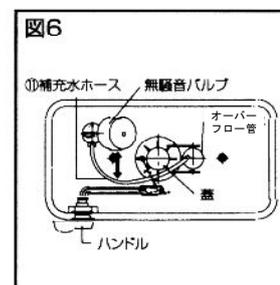
6. 補充水ホースをオーバーフロー管へ接続する時、ホースとバルブのフロートが共に重なり合わないよう注意して下さい。
